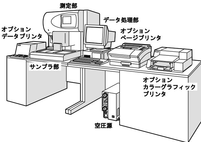
オプションとしては 100 検体サンプラ（またはコンベアシステム）、エアフィルタ、排液監視ユニット、消音ボックス、後面カバー、ハンディバーコードリーダ、データプリンタ、カラーグラフィックプリンタ、レーザプリンタがあります。
