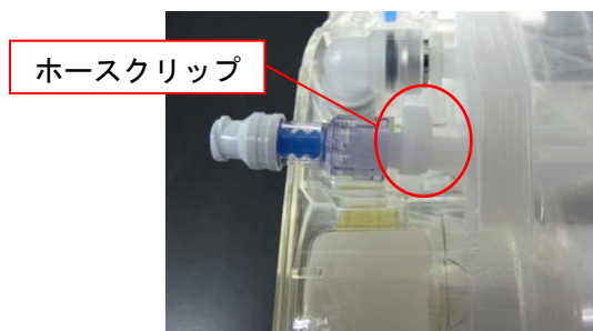
図 5-8 : リザーバポートの補強
