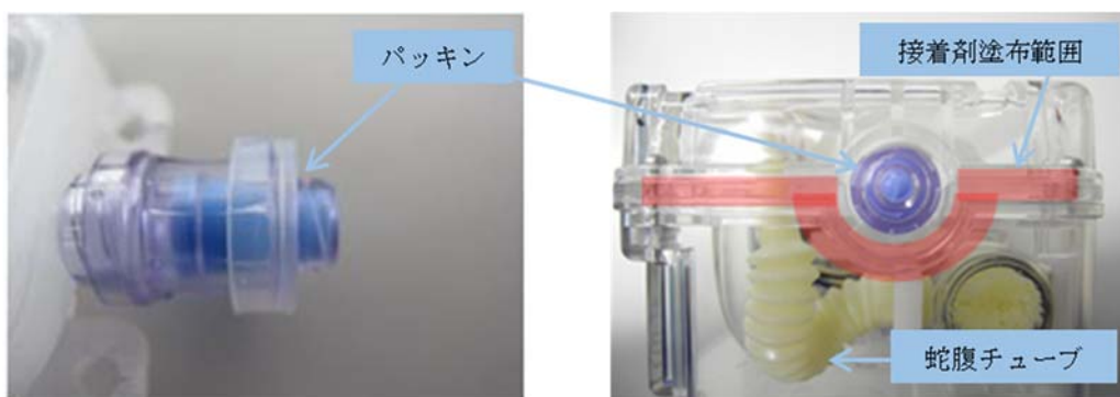
図 5-8：リザーバー補強ポート部へのパッキン追加および接着剤の塗布
