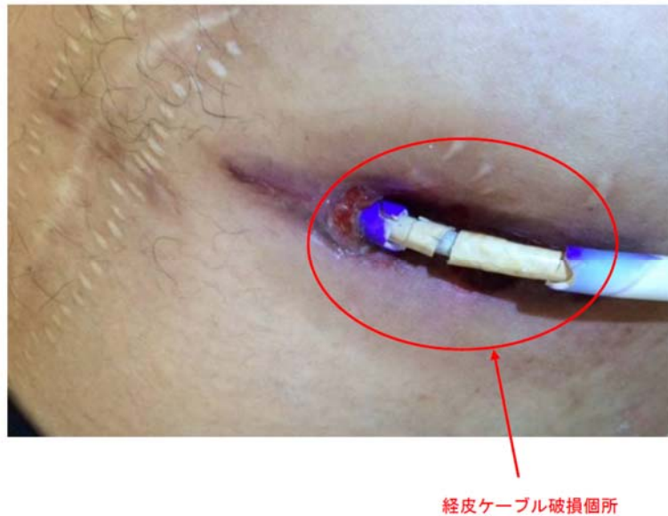
図 5-2： 経皮ケーブルの外層シリコン材の劣化
