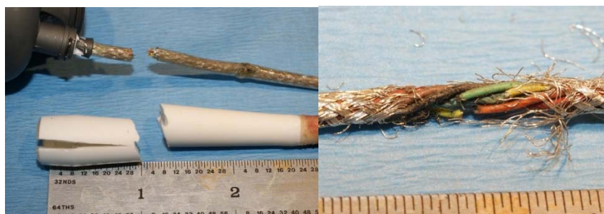
図 5-17：（左：血液ポンプのベンドリリーフ、右：損傷内部）
