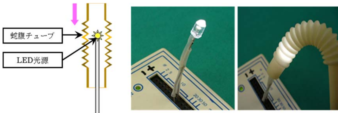
図 5-13：LED 光源による成形時の樹脂充填ムラ確認工程
