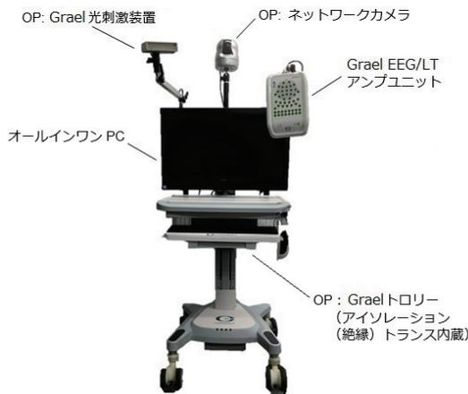
本装置は、「アンプユニット」、「オールインワン PC」と付属品からなります。付属品の「Grael トロリー」に搭載することにより、機器の移動ができます。
