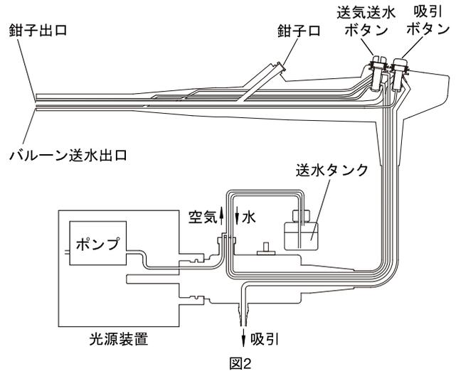
送気送水ボタンの穴を塞ぐことにより先端までの管路がつながり先端より空気が吹き出します。
