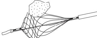
操作部の操作棒が破断する。
