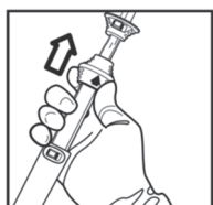
図 9: 必要に応じて、黒色カテーテルハブを慎重に引き戻す(ハブにある矢印「3」が示す方向)。内視鏡視画像で消化管内に内視鏡マーカが 2~3mm 以上見えていることを確認する。
