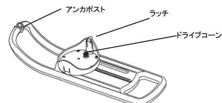
モータドライブ・ユニットをディスポーザブルスレッド(滅菌済)に装着した状態
