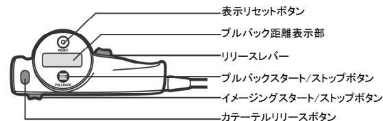
\* ※通常ブルバック(0.5mm/秒、1.0mm/秒)のみが使用可能なMDU5プラスと、高速ブルバックにも対応したMDU5プラスFPBがある。MDU5プラスFPBは、リユーザブルスレッドとのみ使用可能である。
