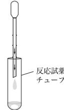
③反応試薬チューブに、テストストリップを矢印の方向が下向きになるように入れます。その後は、反応が終了して目視判定できる状態になるまで、テストストリップを触ったり動かしたりしないで下さい。
