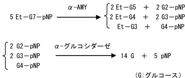
検体中の AMY は非還元末端をエチリデンで修飾した Et-G7-pNP に作用し、G2-pNP、G3-pNP 及び G4-pNP に加水分解します。この反応系に α-グルコシダーゼが作用し G2-pNP、G3-pNP、G4-pNP から pNP が遊離するので、pNP の増加速度を分光学的に測定することにより、検体中の α-AMY 活性を求めます。
