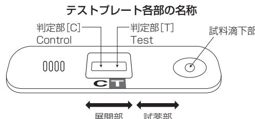
テストプレートの試料滴下部に試料を滴下すると白金 - 金コロイド標識抗SARS-CoV-2抗体が溶解し、試料中のSARS-CoV-2抗原と免疫複合体を形成します。この免疫複合体は展開部を毛細管現象により移動し、展開部に固定化された抗SARS-CoV-2抗体に捕捉され、判定部[T]に白金 - 金コロイドによる黒色のラインを形成します。本キットはこの黒色のラインを目視で確認し、試料中のSARS-CoV-2抗原の存在の有無を判定します。
