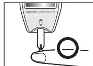
**注意** Gセンサー挿入後、測定待機の画面を表示している間（5分間）に血液を吸引しないと測定はできません。測定待機の画面表示が消えてしまったときはGセンサーを抜き取り、再度差し込んでから血液を吸引させてください。
