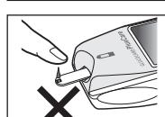
**注意** 血液は右図のように確実に吸引させてください。血液量が十分でない場合は表示部に「E-9」が表示されてブザーが鳴ります。新しいGセンサーで測定しなおしてください。
