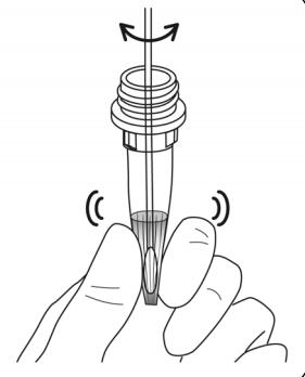
③フィルターを装着して、容器を数回、軽く揺すって十分混和し、試料とします。
