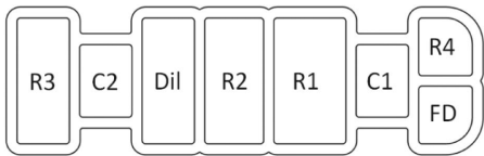
試薬カートリッジの試薬配置図(上面)
