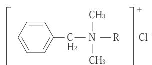
R : C<sub>8</sub>H<sub>17</sub>～C<sub>18</sub>H<sub>37</sub>で主としてC<sub>12</sub>H<sub>25</sub>及びC<sub>14</sub>H<sub>29</sub>から
