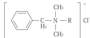
R : C<sub>8</sub>H<sub>17</sub>～C<sub>18</sub>H<sub>37</sub>で主としてC<sub>12</sub>H<sub>25</sub>及びC<sub>14</sub>H<sub>29</sub>からなる
