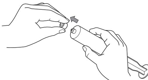
2. シリンジポンプにセットする前に、十分注意してバレル内のエアを抜き取った後、シリンジ先端に、注入ラインの接合部をしっかりと装着・ロックする。
