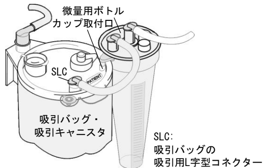
図 7: 微量用ボトルのキャニスタへの取り付け
