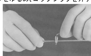
(5) 軟質ブラシを使ってチャネルの管腔を清掃し、超音波洗浄してから水洗い後、圧縮空気で乾かす。
