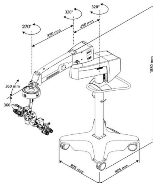
S 88フロアスタンド 重量：約 215kg（顕微鏡基部重量を含まず）
