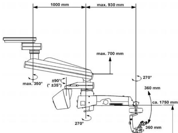
S 8 天井懸架装置 重量：約 200kg (顕微鏡基部重量を含まず)
