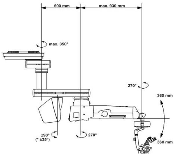
S 81 天井懸架装置 重量：約 178kg (顕微鏡基部重量を含まず)
