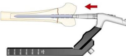
3. 適切なドリルとスリーブを使用して、スクリューの横止め操作を行う。必要に応じて、カウンターハンドルやホロウリーマーを用いて、スレッド付スリーブを取り付ける。スクリューの横止めが終了した後、ネイルからターゲットデバイスを取り外し、クロージャースクリューを挿入する。
