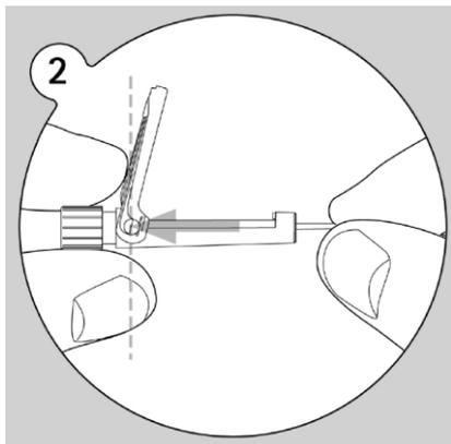
9. コネクタハウジングとハウジングスナップの先端同士がしっかり噛み合うまでハウジングスナップを押し込む。
