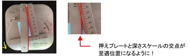
④固定ネジを締めて固定する。
