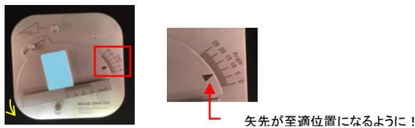
③固定ネジを締めて固定する。
