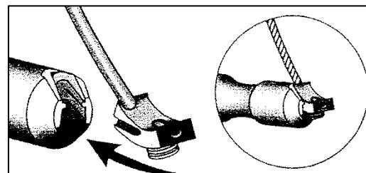
1. ケーブルを通す前に、ケーブルの先端にある締結コネクター本体をケーブルテンショナーに取り付ける。
