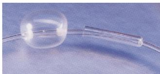
**Step2: 内頸動脈用バルーンが過膨張したときは、圧調節用バルーンに誘導され、動脈の損傷を回避できる。**
