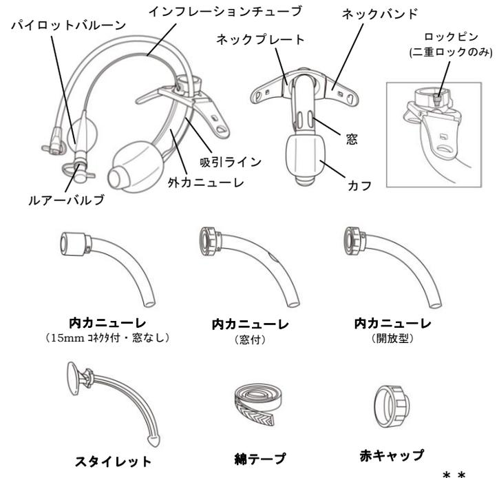
CF-S (二重ロック) は、内カニューレ (15mm コネクタ付、窓なし) のスライドロックを施錠するロックピンを備える。 \*\*
