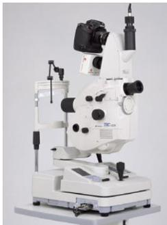
連動し、照明光学系に配置した照明絞りが切替わり、撮影に適した照明光量に調整する。
