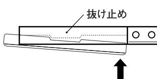
\*替刃をお取り替えになる場合、替刃の先端部を下方にずらし、抜け止めから替刃がはずれたことを確認の上、ゆっくりと抜き取ります。
