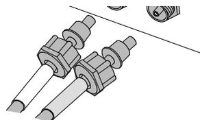
3) チューブのカラーラベルと本体背面ラベルの色を合わせて、2本のチューブをそれぞれのソケット中央のノズルに差し込み、チューブ先端がソケットの奥に当たるまで確実に差し込む。
