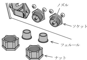
2) ダブルフットスイッチの2本のチューブに取りはずしたナットおよびフェールを、右図のように通す。
