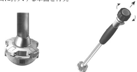
6. 臼蓋コンポーネントを正確にインサーターハンドルに装着し、臼蓋コンポーネントを外転角が40~45度、前捻角が15~20度に位置するように挿入する。
