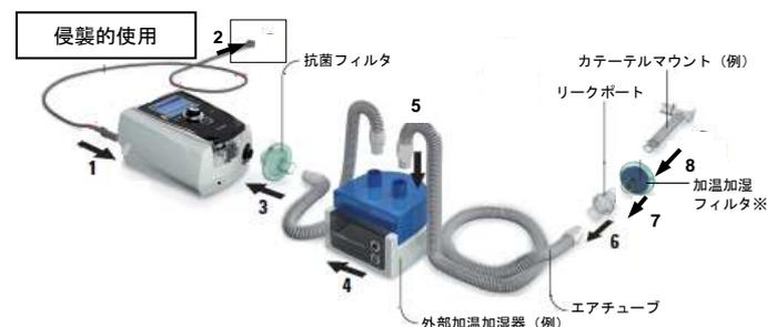
※「外部加温加湿器」と加温加湿フィルタはいずれか一方を使用する。決して両方を併用しないこと。
