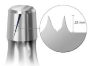
図 A: 0.25mm を超える高さの傷や損傷があるテーパー部分
