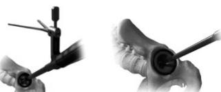
3. 試整復後、アセタブラー・シェルを設置し(アピカルホール プラグは使用しないこと)、適切なサイズの本品を設置する。
