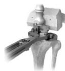
5. 膝蓋骨を切除し、膝蓋骨コンポーネント設置の準備をする。
