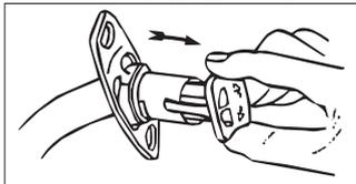
3. 少量の水溶性潤滑剤をチューブ外側とオブチュレータ先端に塗布し、挿入しやすくします。
