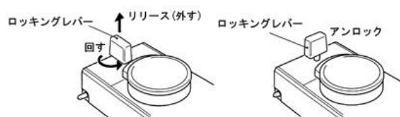
マニホールドから気化器を外す(アンロックする)
