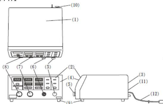
本体寸法: 幅 400 mm × 長さ 400 mm × 高さ 210 mm
