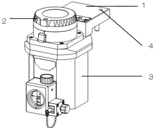
レール・タイプは、1：ガスイン・アウトレット（ガス受入れ・排出部）、2：濃度調節ダイヤル（麻酔濃度調節部）、3：気化室および麻酔薬貯留室（麻酔薬貯留気化部）の構成になる。
