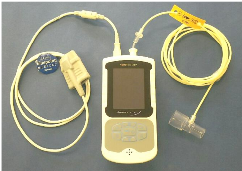
カプノトゥルーASP本体 及び (左) リューザブル SpO 2 センサ (右) 成人気道アダプタ L
