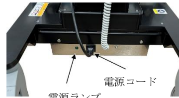
電源コード 電源ランプ 緑：通電状態 消灯：非通電状態
