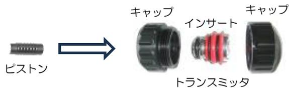
1) ハンドピース、トランスミッタ分解の機会に、トランスミッタインサートのピストン衝突部を特に入念に点検する。傷、裂け目、潰れがある場合は、トランスミッタの交換が必要。
