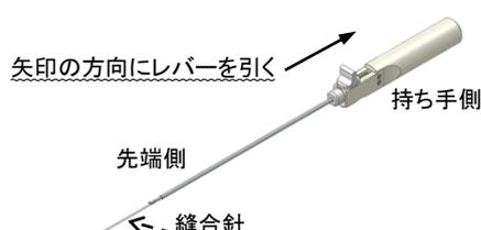
(4)縫合針を外す際は、レバーを先端側に最大まで押し、縫合針を引き抜く。
