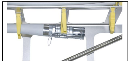
図5： カメラケーブル接続部がシリコンホルダ（下部）に固定された状態
