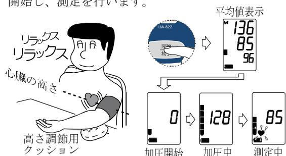
4. 測定が終了すると測定結果と血圧レベル(※2)を表示し、自動的にカフに残った空気を排気します。測定中に不規則な脈が含まれていた場合 IHB マーク(※3)を表示します。
