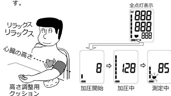
4. 測定が終了すると測定結果と血圧レベル(※1)を表示し、自動的にカフに残った空気を排気します。測定中に不規則な脈が含まれていた場合 IHB マーク(※2)を表示します。
