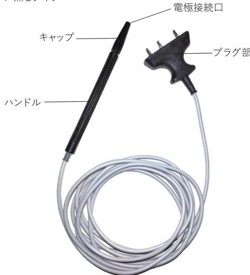
電極接続口内径:1.6mm ケーブルの全長:3m±10%
