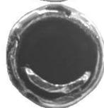
B: 片側のロックングプレートが脱落した製品
