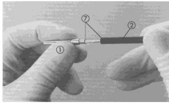
3. ①のジョウを持って、②の OUTERシースを1/4回転させ、インサートを抜き出す。
