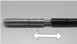
このとき、左図のように先端が抜ける場合、シャフト内のハーフプレートが磨耗しているか、アウターシースの接合部分の不具合が考えられるので使用を
