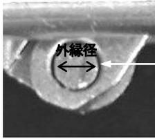
磨耗によりリングがはっきり見える状態（ほぼリベットの軸径に等しい）
