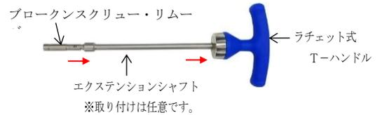
②-6 ラチェットを‘REVERSE’にセットし、強く押し込みむようにハンドルを回旋させ、操作する。
